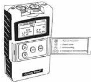
2. Ein-/Ausschalter und Intensitätsregler: Wenn sich beide Regler in der Aus-Position befinden, ist das Gerät ausgeschaltet. Durch Drehen der Regler im Uhrzeigersinn wird der entsprechende Kanal eingeschaltet und die Betriebsanzeige (CH1 oder CH2) erscheint auf dem LCD.
